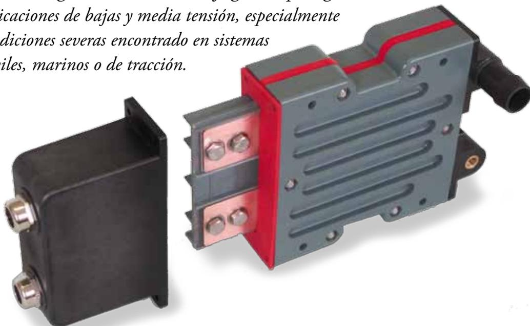
Manufacturadas de los materiales avanzados, la EV2 es un diseño patentado que encapsula y separa totalmente los elementos de resistencia del refrigerante, ofreciendo una solución modular, ligera, de poco volumen y de alta potencia para aplicaciones de refrigerado por agua. Unidades pueden combinarse juntos para manejar energías de 10kW a 1.0MW.
