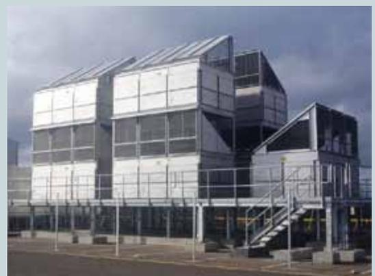
Banco de carga trifásico de Cressall de 17.225MW para hacer una prueba de carga del sistema de distribución de 11kV del nuevo portaaviones británico de la Marina Real.
